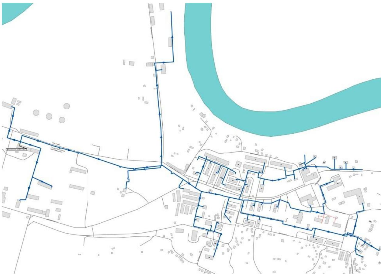
**Рисунок 2. Схема тепловых сетей сельского поселения Каркатеевы**
