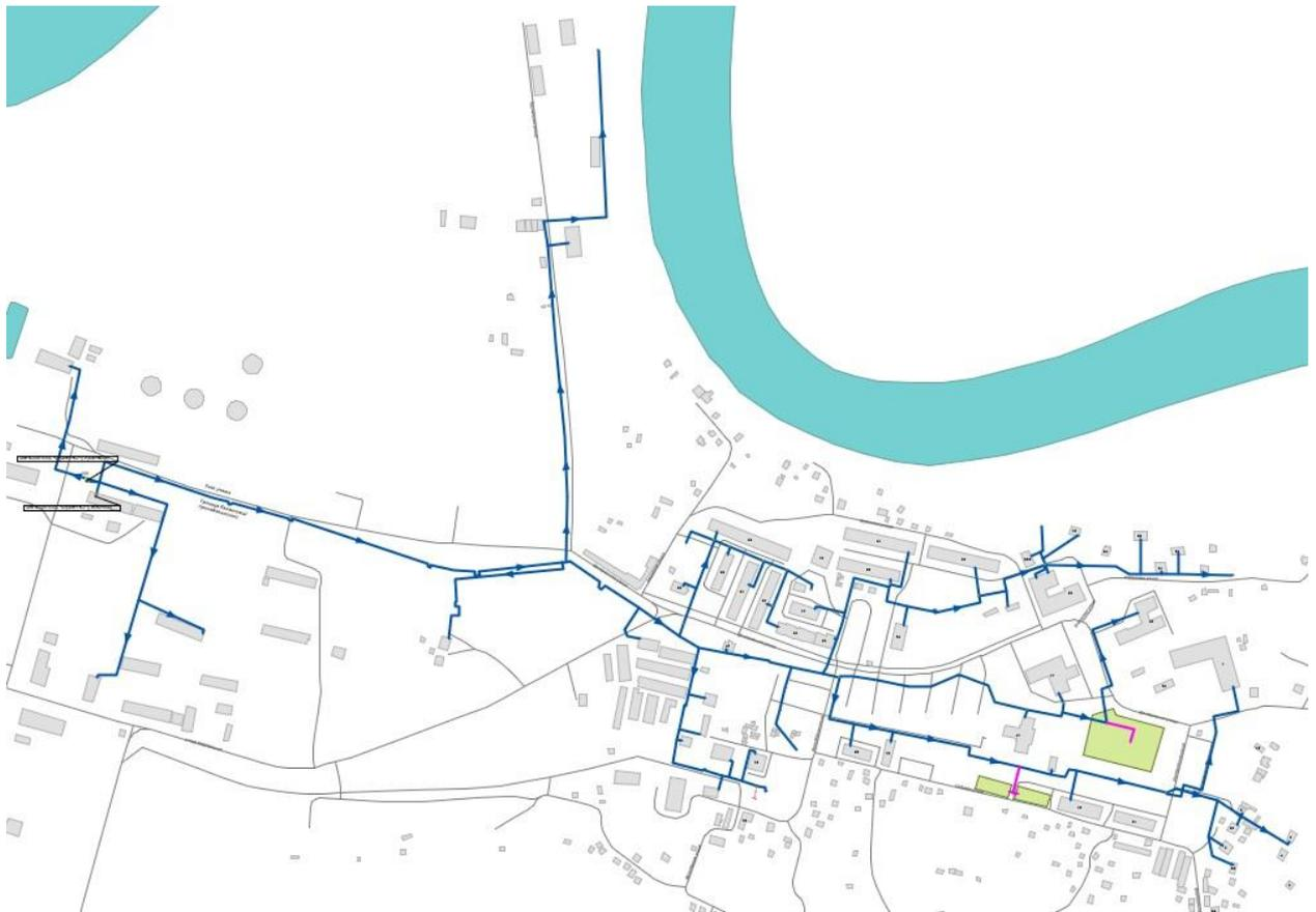
**Рисунок 6. Перспективная система теплоснабжения с.п. Каркатеевы**
